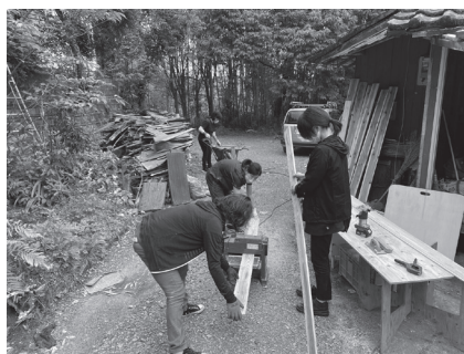
写真3 自動カンナでの加工作業
